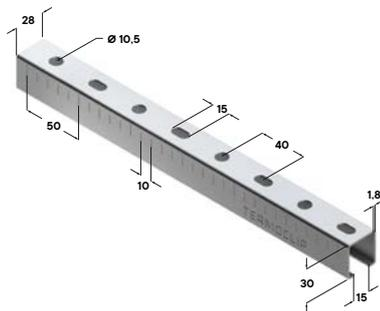
Профиль монтажный – шина С-образной формы с монтажными отверстиями предназначен для быстрого горизонтального и вертикального монтажа легких и средних инженерных систем, систем вентиляции и кондиционирования, электроснабжения, трубопроводов, а также для изготовления стенных консолей, стеллажей и рам различного типа. Рекомендуется для применения в сухих и влажных помещениях.
