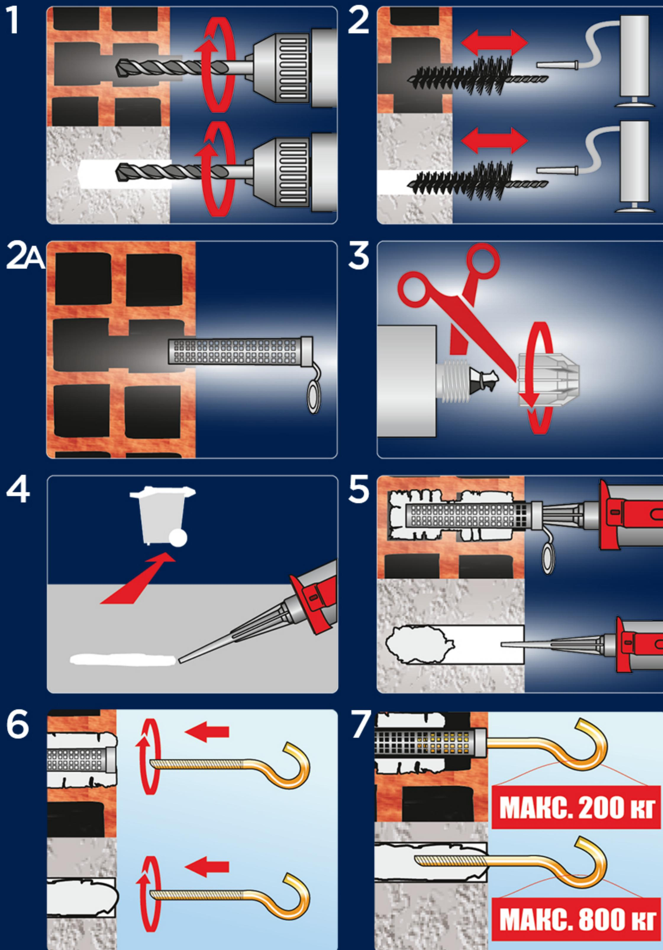
1. Просверлите отверстие на 2 мм больше монтируемой шпильки или арматуры. При монтаже с помощью гильзы диаметр и глубина отверстия равны диаметру и длине гильзы.
