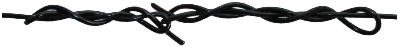
Соединения двух отрезков троса ремонтным узлом
