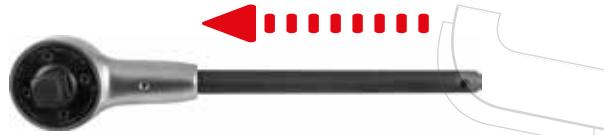
2. Установить адаптер-предохранитель в гнездо мультипликатора. Используя шестигранный ключ 6 мм затянуть винт для фиксации адаптера, как показано на фото.
